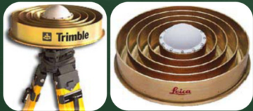
Blindagem em antenas para bloquear sinais de multicaminhamento Multicaminhamento: Receptor recebendo diversas vezes o mesmo sinal
