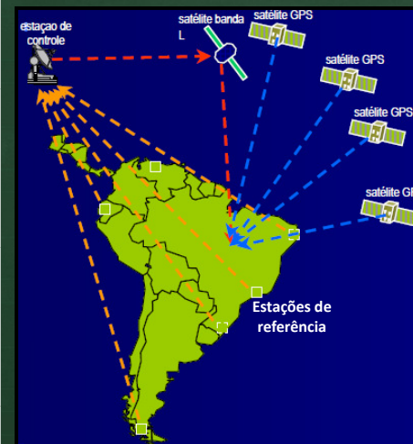
Diagrama de operação do sistema WADGPS
